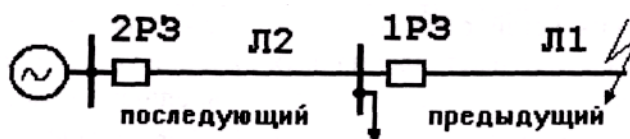
Рисунок 11.1 – Расчетная схема для выбора уставок релейной защиты (РЗ)
